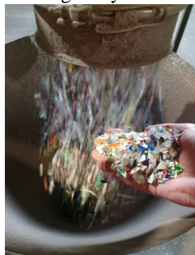
Figur 2: Kværnet og vasket PP plast
